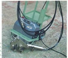
[POWER TOUCH]係以100V 電壓的油壓組作為動源,藉由 附屬配備的交換可修理矯正 鋼管、門架、支柱及腳踏板 等種種架設器組件。
