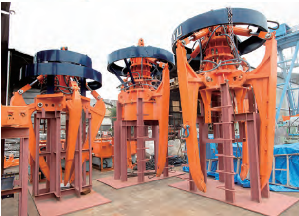
危険をとまぬ潜水士の作業上のリスクを解消する、遠隔操作による無人テトラポッドキャッチャー（消波ブロック吊上装置）。3本爪や4本爪の油圧グラブは最大80tの吊り上げ能力がある
