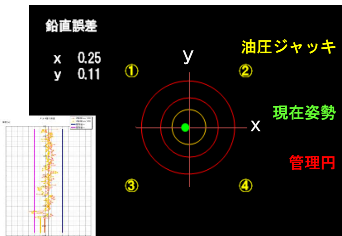
精度管理モニタ 傾斜角管理画面
